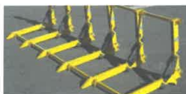
Barrières mobiles anti-bélier amovibles (modulable, sans ancrage au sol, mise en œuvre sans engins, installation en quelques minutes, certifiés anti-bélier IWA14 (7,2t à 50 km/h et/ou BAS PAS68 (7,5t à 50km/h)
